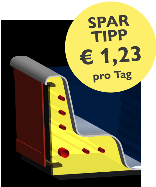
Vollschaumisolierung als thermische Barriere - die energieeffizienteste Isolierungslösung auf dem Markt.
